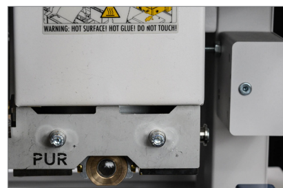
Uzavřený zásobník PUR s aplikátorem lepidla
